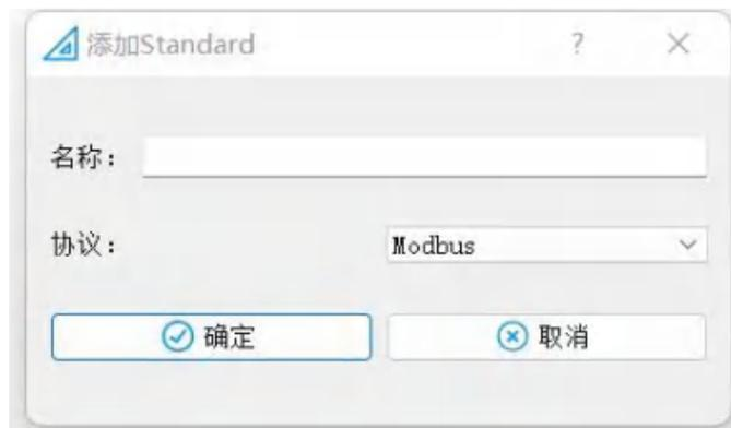
在弹出的对话框中，选中 Modbus 协议，输入 Modbus 名称信息。点击确定添加。
