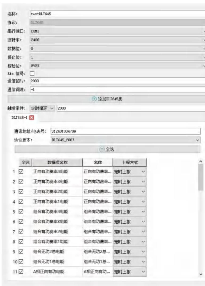
设置通讯参数、根据硬件实际连接选择 COM 口，一搬通讯波特率 2400、数据位 8、停止位 1、校验位 EVEN。
