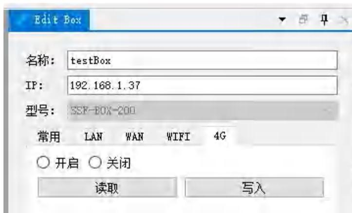
点击切换到 4G 标签页，可执行读取和设置 4G 开关。设置关闭 4G 时可能无法连接 MQTT 服务器。
