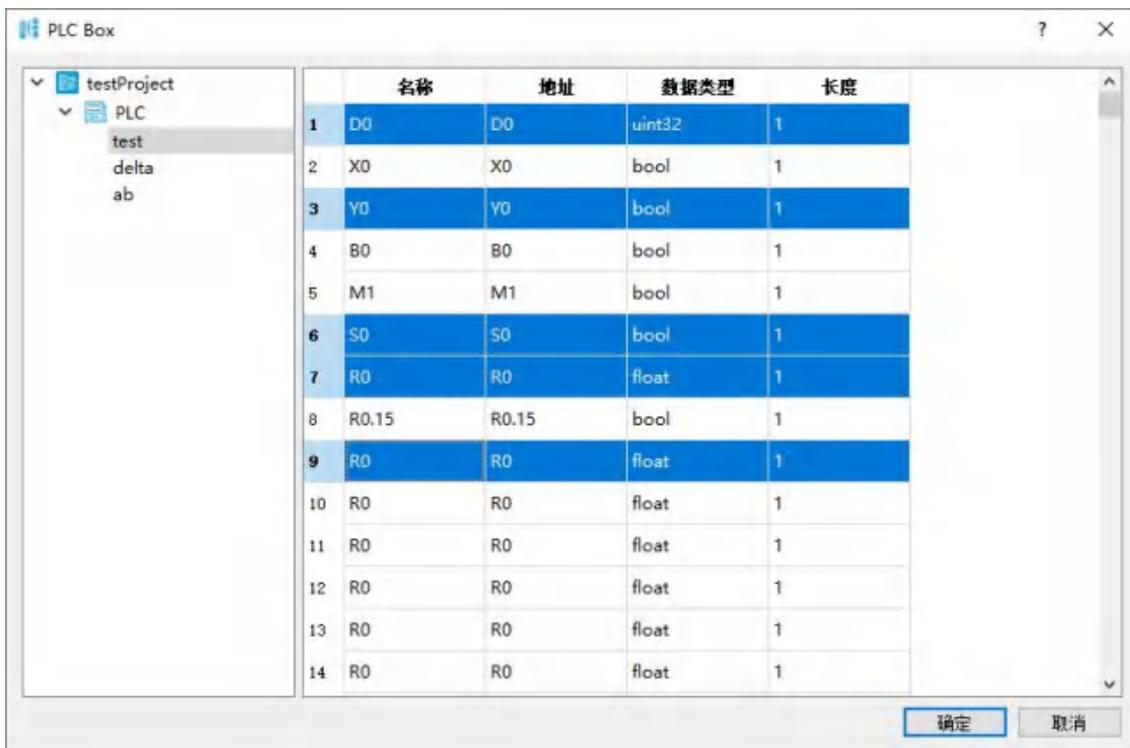
在右侧选择要添加的数据点，选择完成后点击确定按钮将选择的数据点导入到对应的 Modbus 寄存器中。
