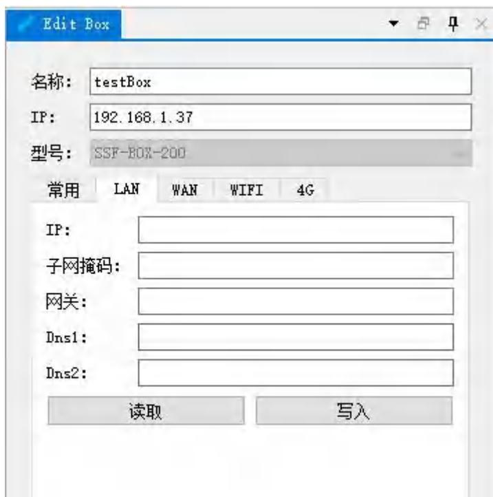
点击切换到 LAN 标签页，可执行读取和设置 LAN 口参数。数据采集时需确保 LAN 口 ip 与 PLC 在同一网段。
