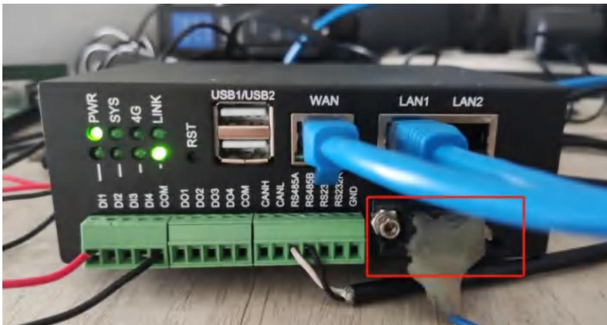
通过 USB 转 485 工具将网关与电脑相连，485 端连接网关 COM2 口（注意线序），USB 端连接电脑，使用串口调试助手进行模拟。
