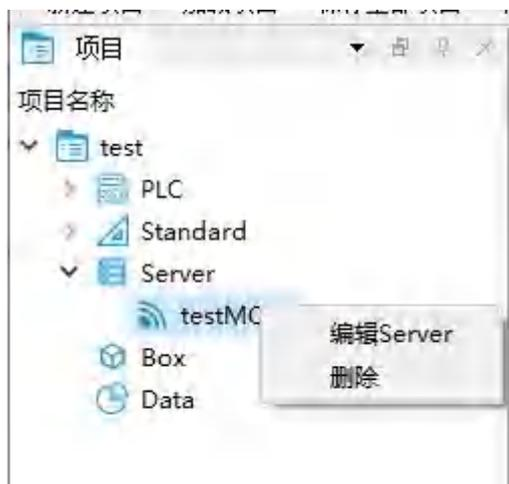
选中要删除的 MQTT 服务器，右键弹出菜单，点击
