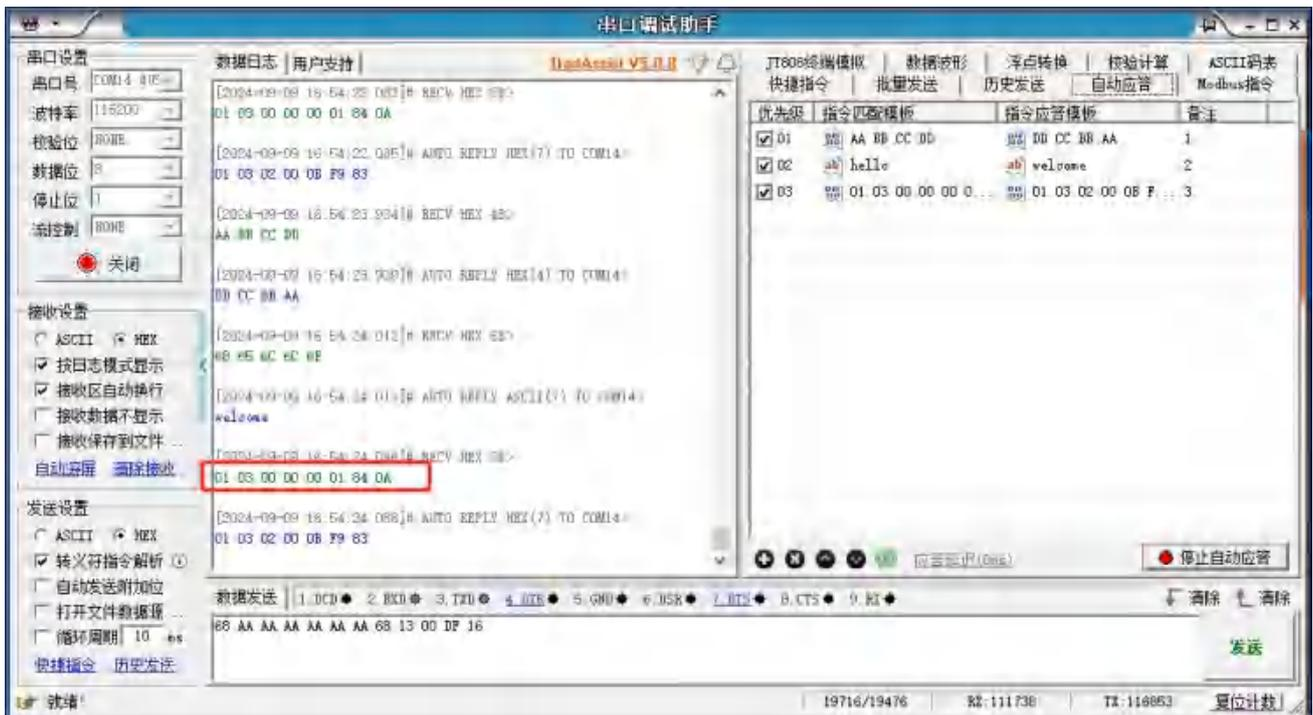
使用串口调试助手模拟，配置自动应答。图中可以看到数据被追加了 ModbusRTU CRC 校验码。
